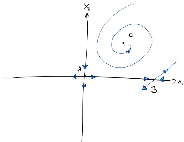
$$(c) \quad \text{Get } x_1 = y \Rightarrow \dot{x}_1 = \dot{y} \\ x_2 = \dot{y} \Rightarrow \dot{x}_2 = \ddot{y} = -\dot{y} - y^3 = -x_2 - x_1^3 \quad \dot{x} = 0 \Rightarrow x_1 = x_2 = 0$$
