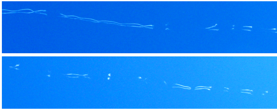
Abbildung 5. Zerfall der Wirbelschleppen eines Flugzeuges durch die sogenannte Crow-Instabilität, die durch Wechselwirkung der Wirbel mit den Kondensstreifen der Düsenabgase sichtbar wird. Die untere Hälfte des Bilds setzt die obere Hälfte rechts fort. Aus http://commons.wikimedia.org/wiki/File:The_Crow_Instability.jpg .
