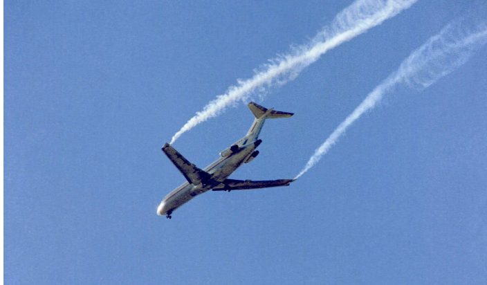
Abbildung 4. Wirbel an den Flügelspitzen einer Boeing 727, ein Indiz für die um die Flügel herrschende Zirkulation, die für die Erzeugung von Auftrieb notwendig ist. Die Wirbel wurden durch Rauchgeneratoren an den Flügelspitzen sichtbar gemacht. (NASA-Fotografie ECN-3831.)
